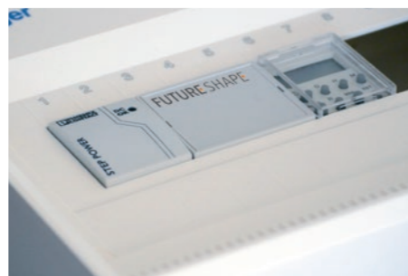
Abb. 4: SensFloor Empfänger (Mitte) mit Stromversorgung und Zeitschaltuhr zum Einbau in eine Hutschiene.
